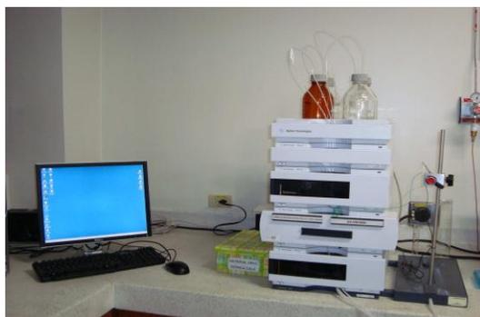
**Figura 5.** Cromatógrafo líquido con detector de arreglo de diodos *Agilent Technologies* 1200 (Miami, FL, EE.UU.) y sistema de procesamiento de datos.
