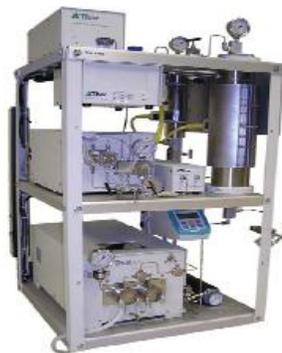
**Figura 4.** Extractor con CO<sub>2</sub> supercrítico *SFE-2000-2-FMC50* (Thar Instruments, Inc., Pittsburgh, PA, EE.UU.).
