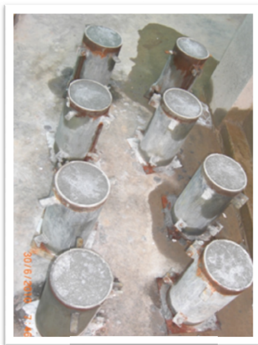
Figura 20. Cilindros listos para curado
