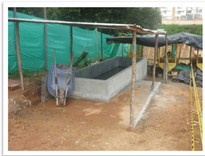
Figura 21. Pila de curado de cilindros
