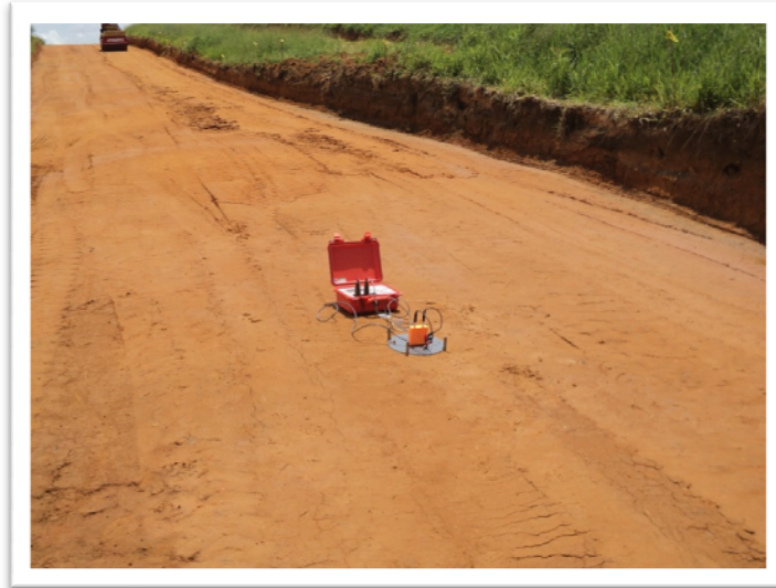
Figura 17. Toma de Densidades con el EDG
