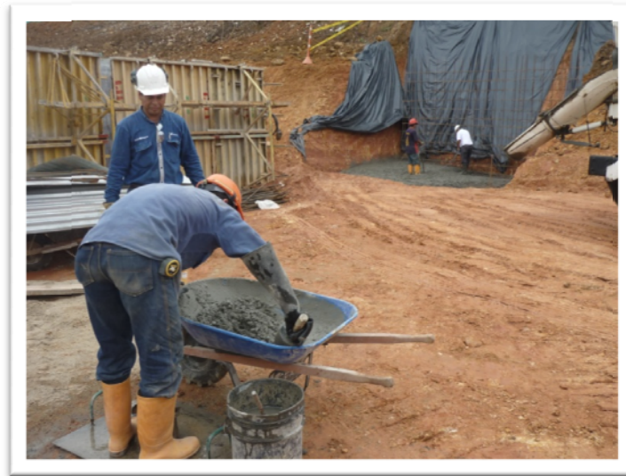
Figura 18. Tomamuestras llenando el cono del ensayo
