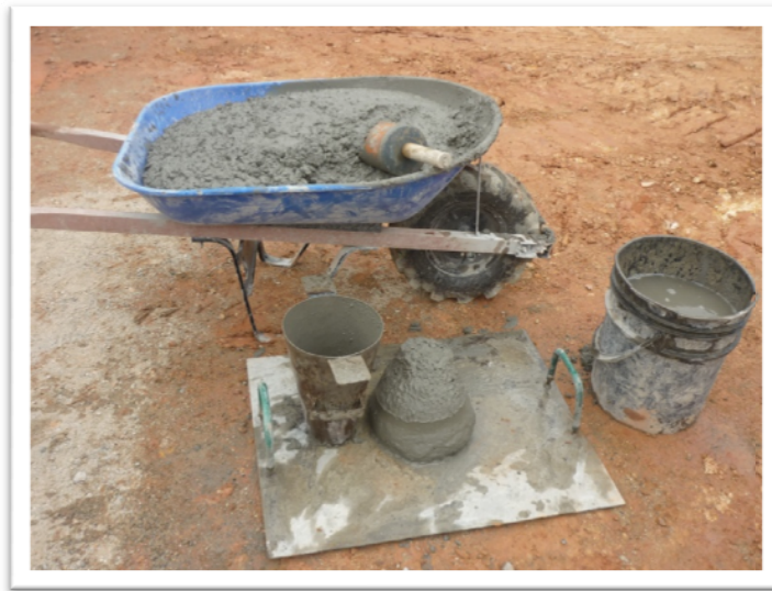
Figura 19. Prueba de asentamiento
