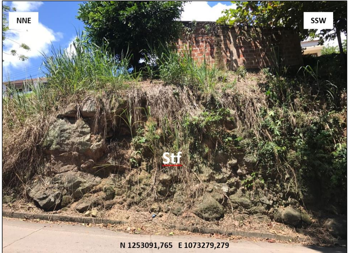
Figura 12. Fotografía tomada al margen derecho de la carrera 19 entre la calle 8 y el puente de Yariguies, en donde se evidencia un depósito cuaternario de origen fluviotorrencial.
