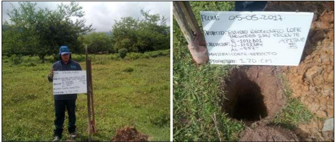
Figura 30. Registro fotográfico del apique No. 5 realizado en la zona de estudio.
