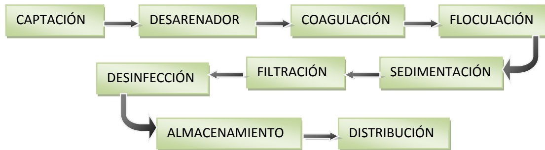
Figura 1. Diagrama en bloques del proceso de potabilización del agua
