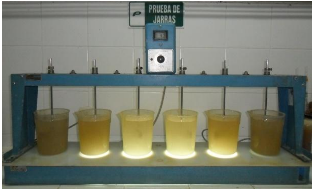
Figura 8. Montaje para la prueba de jarras
