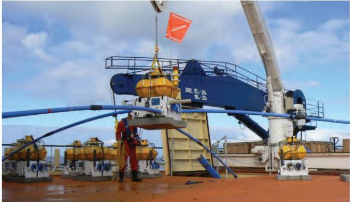
Figura 3-10 Receptor CSEM utilizado en Groenlandia
