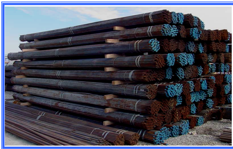
Figura 31. Sartas de varillas en sus empaques.
