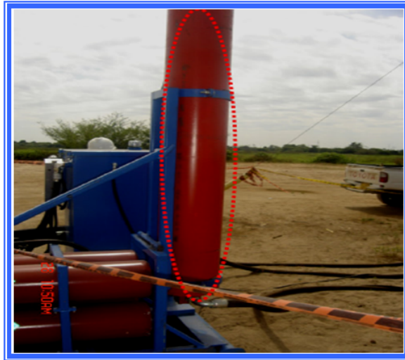
Figura 24. Acumulador de presión.
