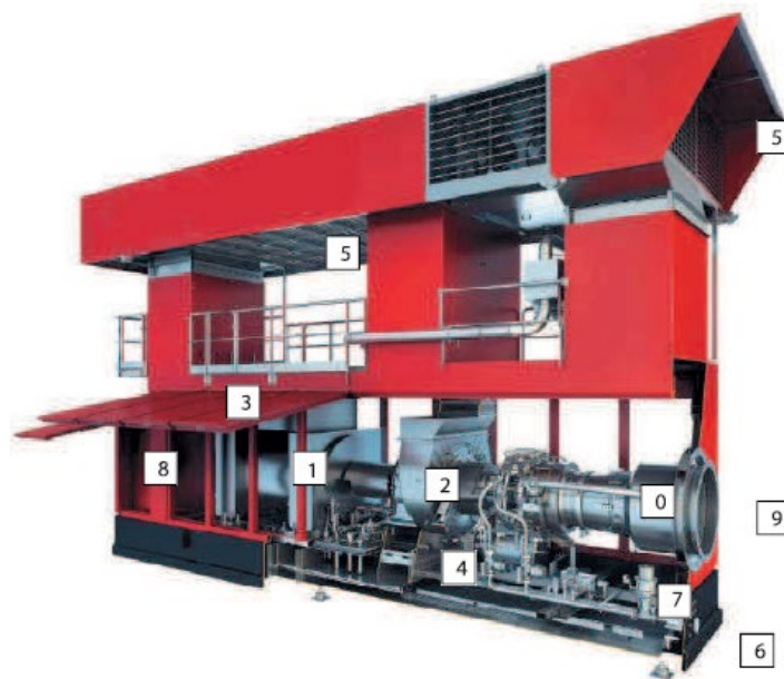
Figura 12. Partes de un turbogenerador
