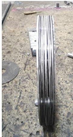
Fotografía 10. Vista de sección de los discos con arandelas de 0,9 mm
