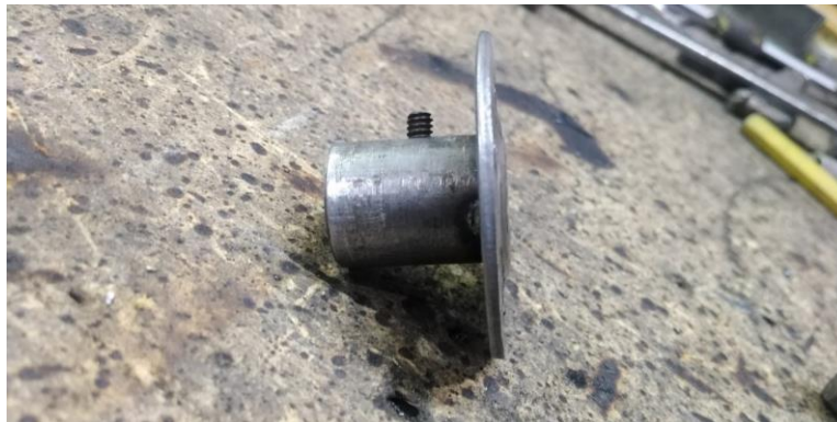
Fotografía 8. Buje con la arandela soldada
