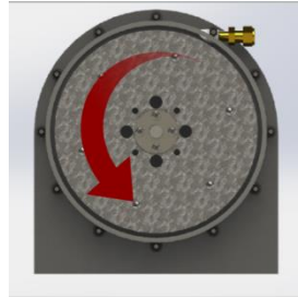
Figura 8. Trayectoria del fluido dentro de la turbina
