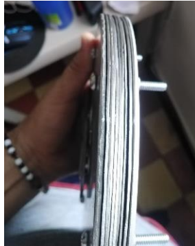
Fotografía 9. Vista de sección de los discos con arandelas de 0,3 mm
