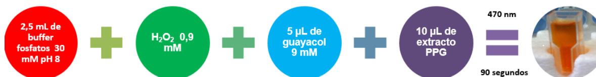
Figura 16. Metodología para la determinación de la actividad enzimática.
