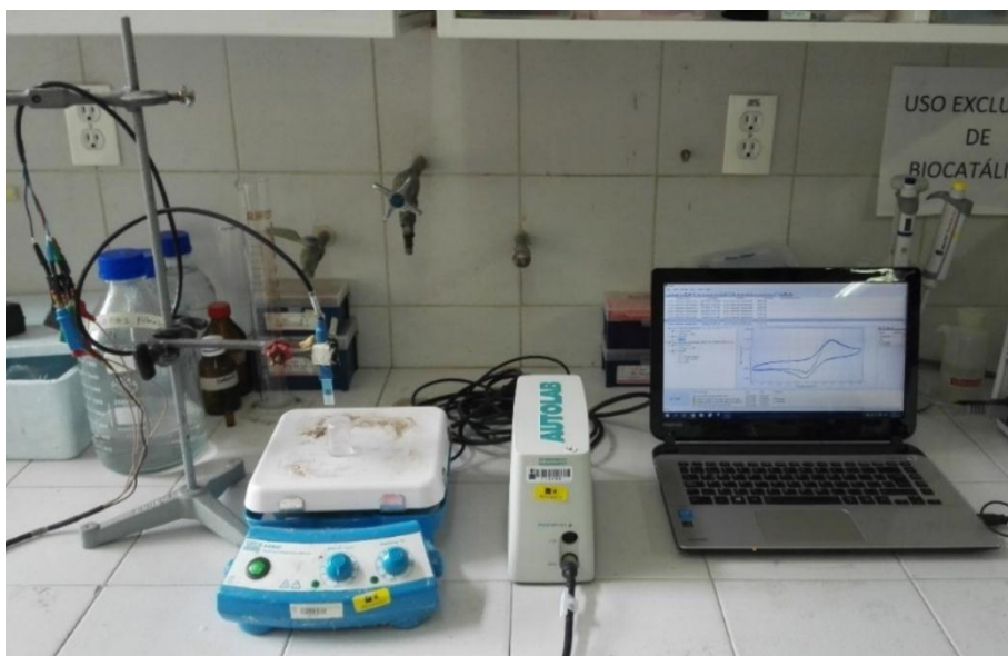
Figura 18. Montaje experimental, equipo AUTOLAB POTENTIOSTAT GALVANOSTAT.
