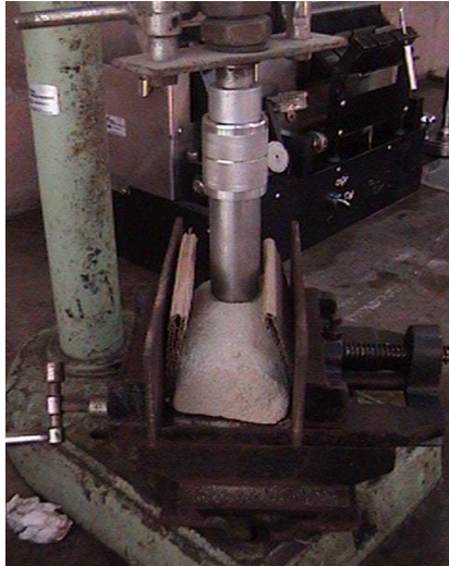
Figura 51. Montaje para la extracción de muestras (plugs) para el campo en Llanito.
