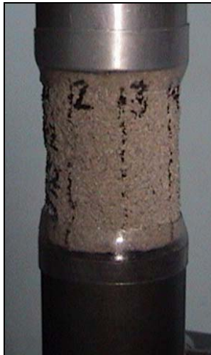
Figura 53. Montaje prueba UCS UIS 18.
