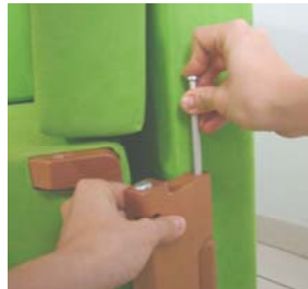
Unir los laterales a los módulos del apoyabrazos, por medio de los pasadores.
