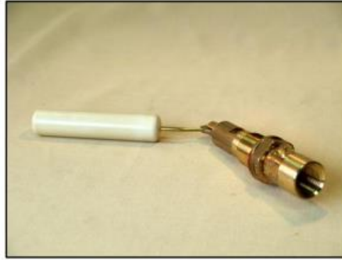
Figura 9. Multiválvula. Adaptada de Estudio del sistema GLP como combustible alternativo de uso en vehículos automotrices. Barrera (2012).
