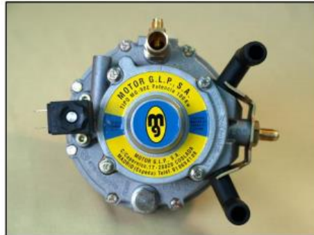
Figura 11. Reductor-vaporizador. Adaptada de Estudio del sistema GLP como combustible alternativo de uso en vehículos automotrices. Barrera (2012).
