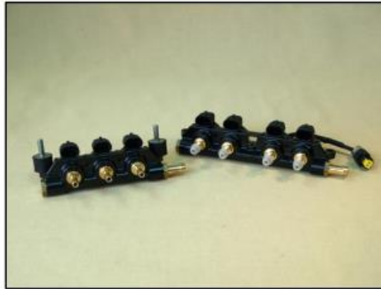
Figura 13. Inyectores. Adaptada de Estudio del sistema GLP como combustible alternativo de uso en vehículos automotrices. Barrera (2012).
