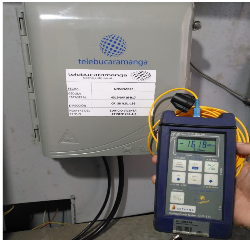
Figura 41. Prueba de potencia de NAP Indoor que arroja un valor de -16.18 dBm.
