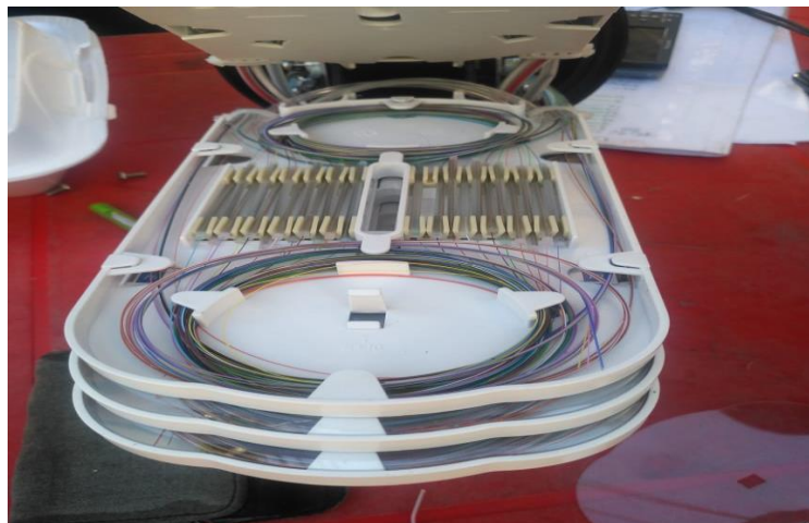
Figura 19. Ubicación de bandejas y splitters dentro de un Domo.
