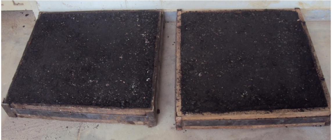
Figura 30. Placas con Mezcla Asfáltica Tibia y Caliente
