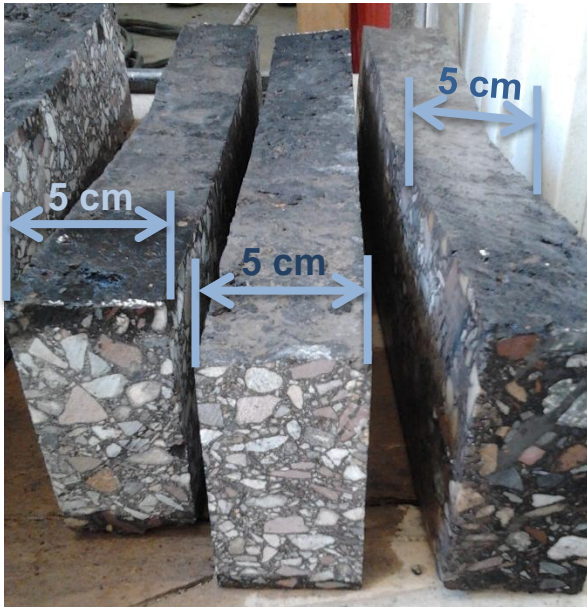
Figura 34. Vigas con 5 cm de Base
