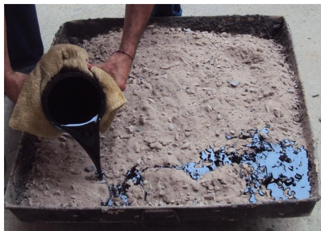
Figura 24. Ligante Asfáltico Vertiéndose
