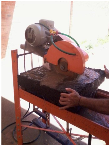
Figura 32. Primer Corte a la Mitad de la Placa
