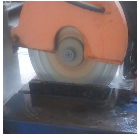
Figura 35. Corte Superior e Inferior de las Vigas
