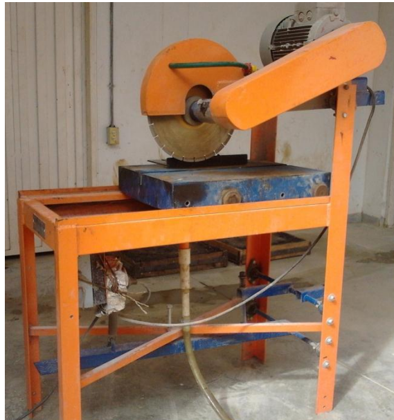
Figura 31. Equipo de Corte de Vigas
