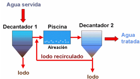
Figura 1 Esquema del proceso de lodos activados convencionales
