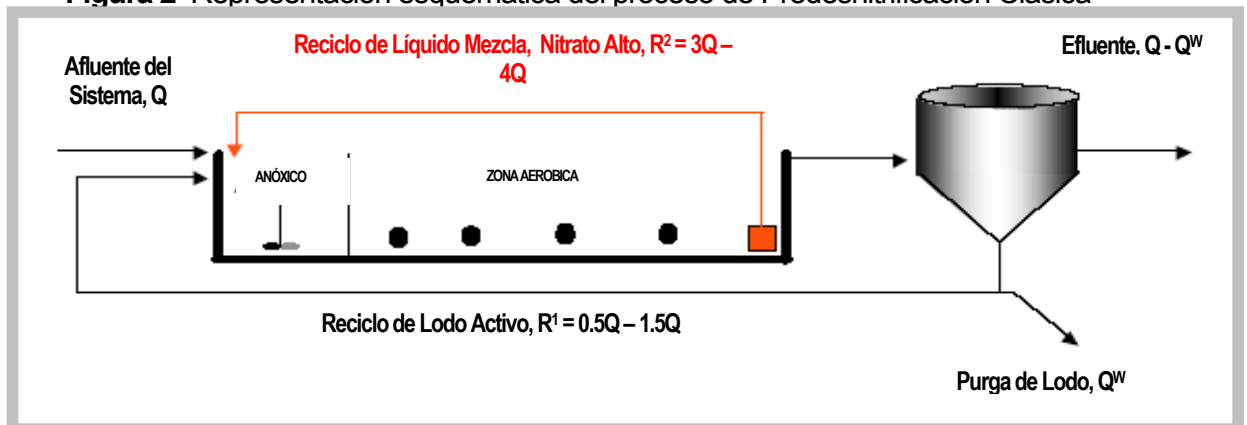
Figura 2 Representación esquemática del proceso de Predesnitrificación Clásica
