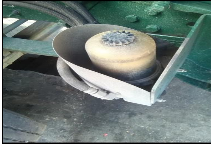
Figura 61. Filtro de combustible
