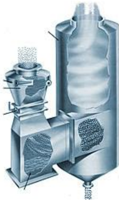
Figura 5. Lavador de venturi conectado a un ciclón
