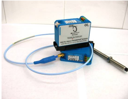
Foto 50. Conexión entre la punta de prueba y el sensor de proximidad.
