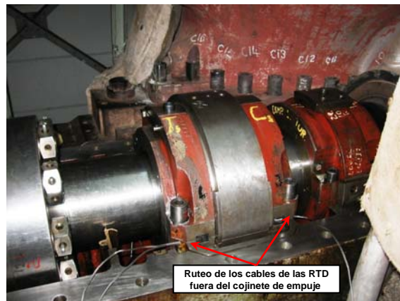
Foto 33. Ruteo de los cables de RTD con los casquetes del cojinete empuje asegurados.
