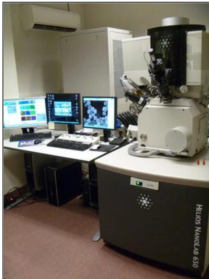
Figura 25. FEI Helios Nanolab 650 del centro Swagelok para el análisis superficial de materiales; Recuperado de Case Western Reserve University; s.f.
