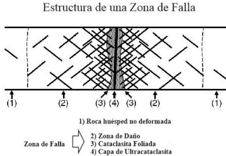
Figura 3. Perfil de una zona de falla.
