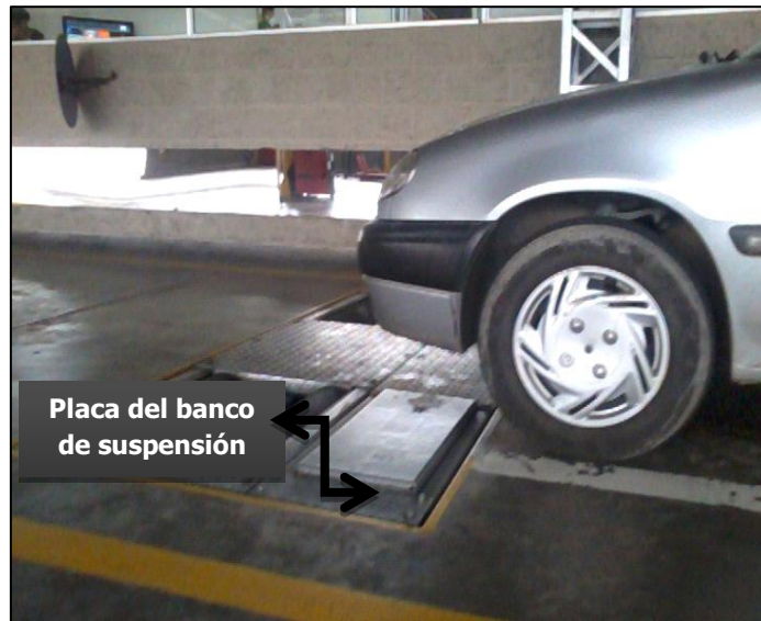
Figura 5. Placa o Plataforma vibratoria del banco de suspensión, imagen tomada con una cámara fotográfica Samsung antes de iniciar la prueba de inspección
