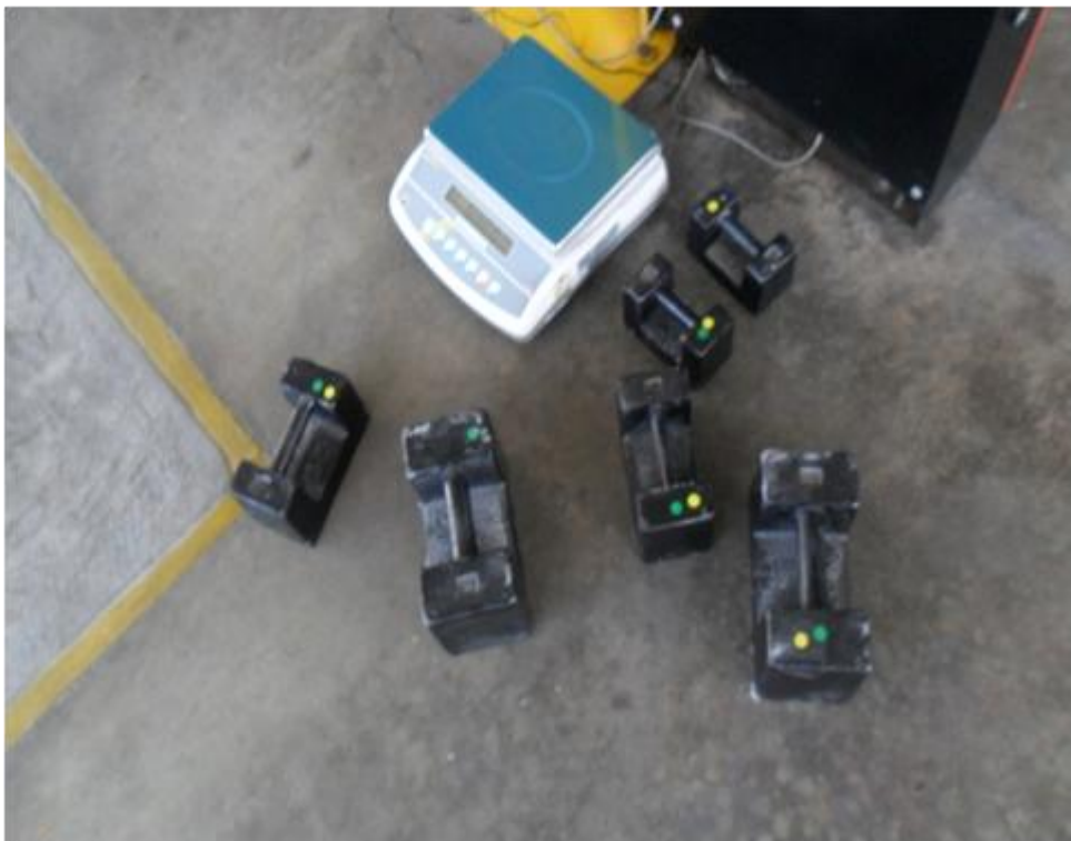
Figura 21. Balanza patrón y masas patrón antes de iniciar con el muestreo.
