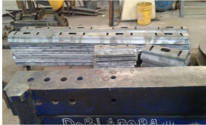
Figura 10. Percha en proceso en dobladora.
