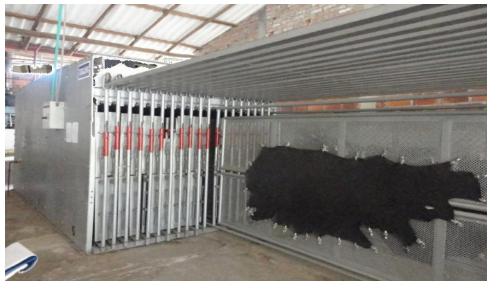
Figura 22. Operación en togli para estirado con flujo de aire precalentado.
