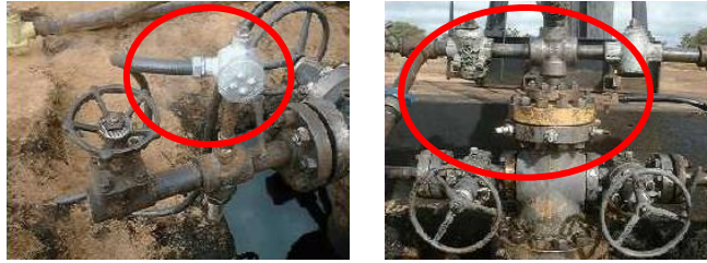
Figura 19. Conexiones de la unidad de acondicionamiento de potencia al tubing Fuente: Eureka Oil Company
