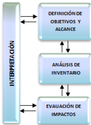
Figura 1. Metodología del Análisis del Ciclo de Vida (ACV). Figura basada en ISO 14040.
