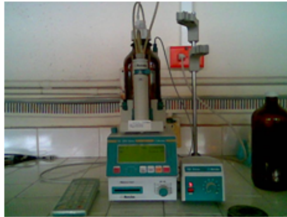
Montaje para realizar la oxidación de cianuros
