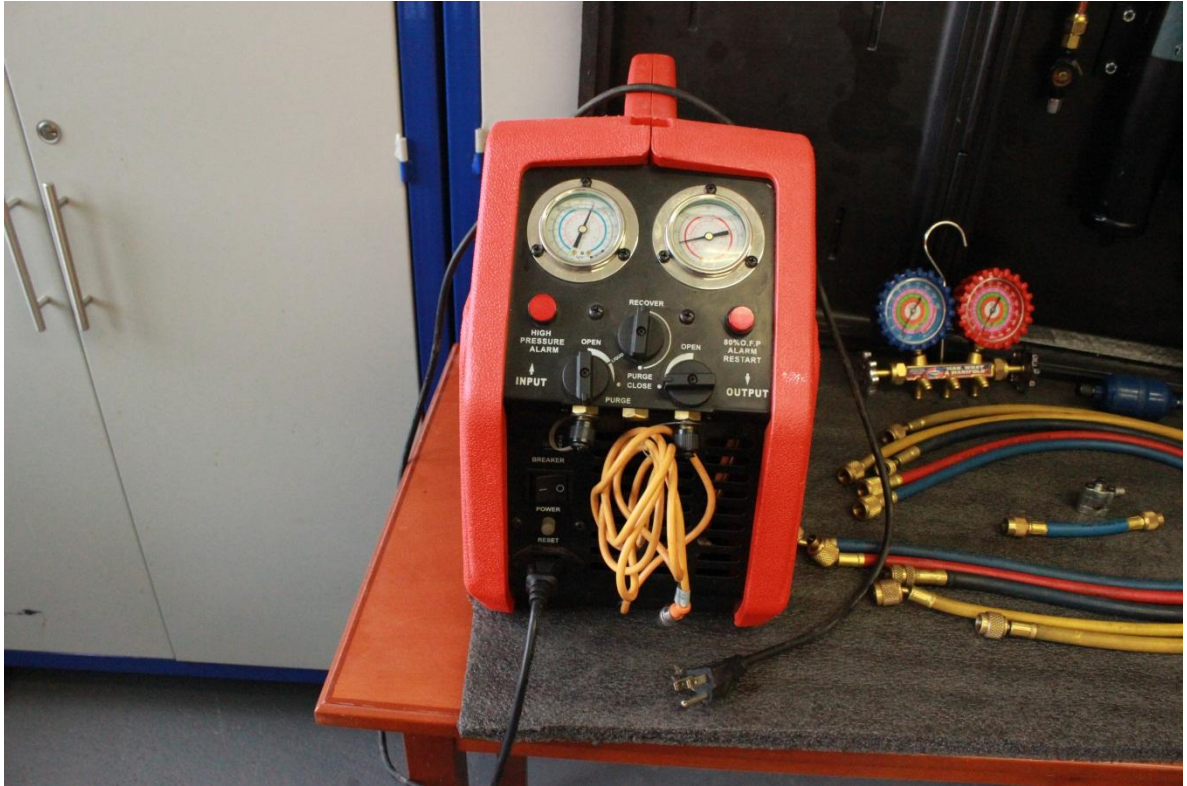
Figura 78. Unidad de recuperación
