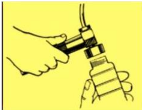
Figura 21: Roscar el tarro de la muestra en la bomba.
