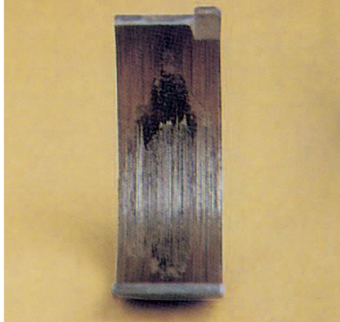
Figura 10. Insuficiencia de aceite en el cojinete.
