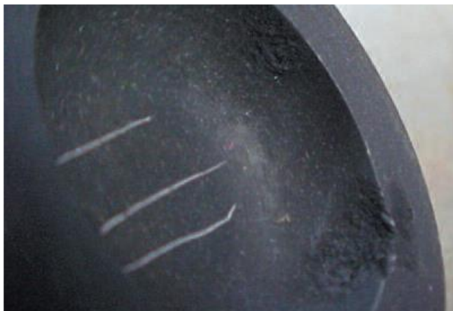
Figura 9. Desgaste por partículas dentro del cilindro.
