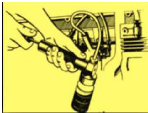
Figura 22: Succionar con la bomba y llenar el tarro hasta el final del hombro del mismo.
