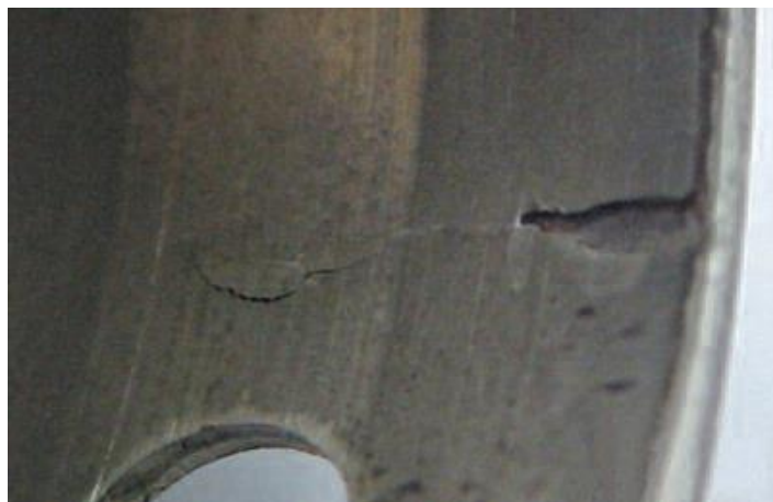
Figura 11. Fractura de aleación.
