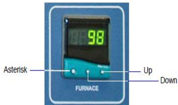
Figura 34. Configuración de la temperatura manual en el equipo HPVA II
