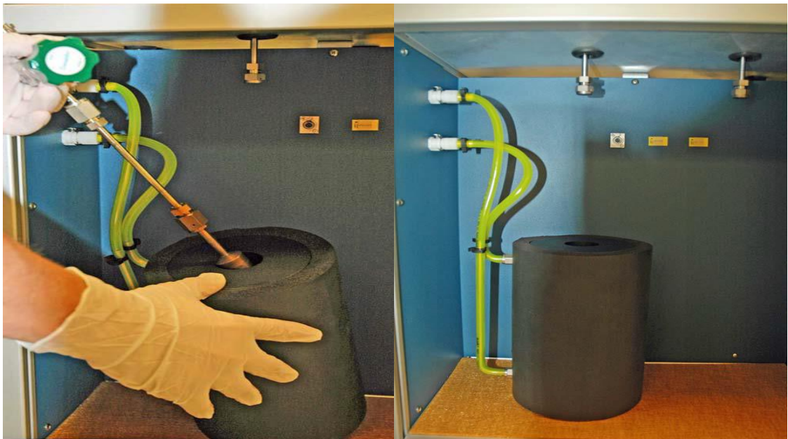
Figura 35. Muestra del cambio de puerto para la unidad de análisis HPVA II
