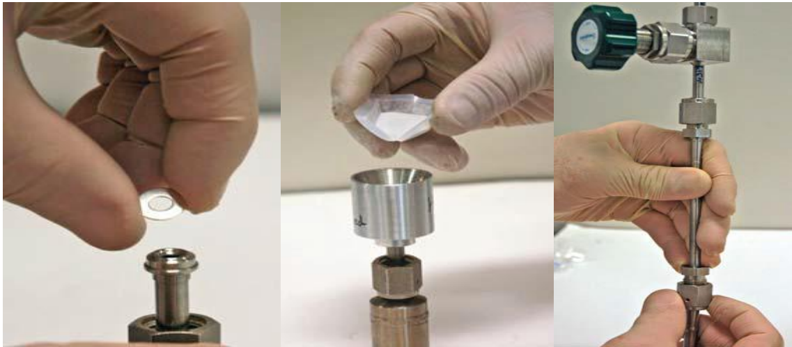
Figura 31. Instalación de la muestra en la celda y la conexión del conjunto en el equipo
