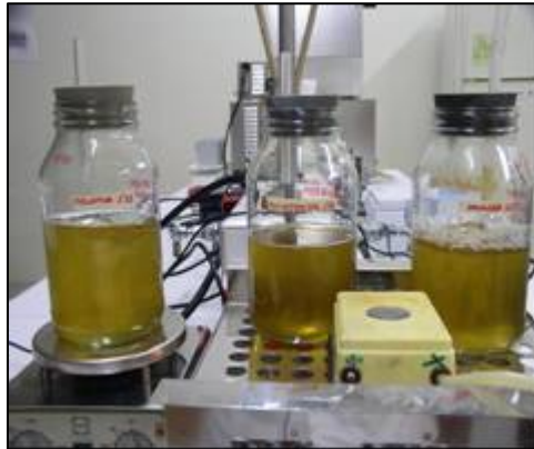
Figura 15. Montaje para la realización de la curva de crecimiento del pool de microorganismos aceleradores
