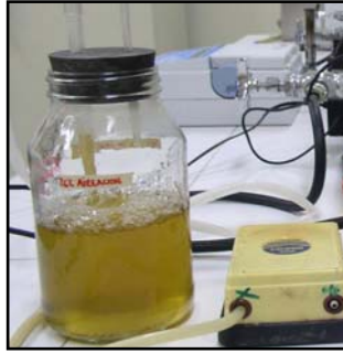
Figura 8. Montaje del Bio-reactor aireado tipo Batch.
