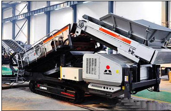
Figura 9. Planta móvil de trituración con criba para la separación de escombros
