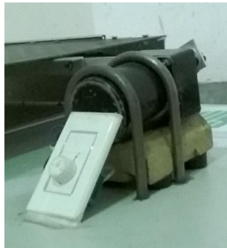
Figura 12. Motor reductor (mesa Vibratoria)
