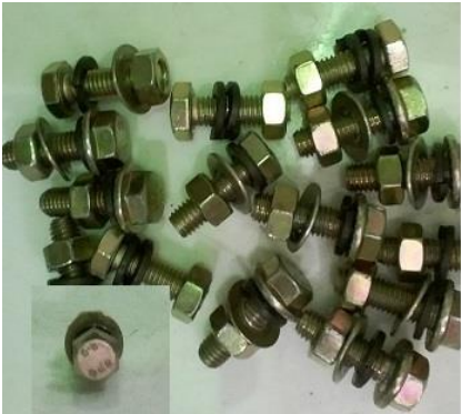
Figura 13. Tornillos 8.8x1” con los que se perno la estructura a la mesa
