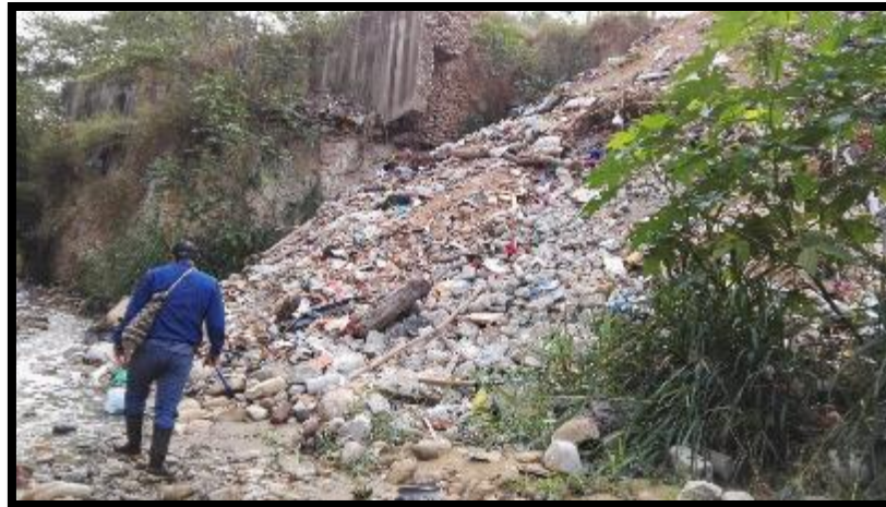
Figura 35. Suelos de llenos mixtos deslizados sobre el cauce de la quebrada Chimita, con presencia de basuras, matriz arenosa y clastos heterométricos.
