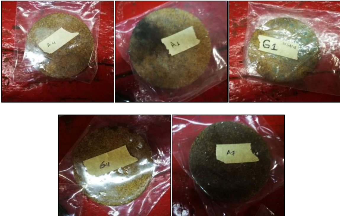
Figura 9. Comprimidos de biomasa obtenidos a temperatura de 120 °C.
