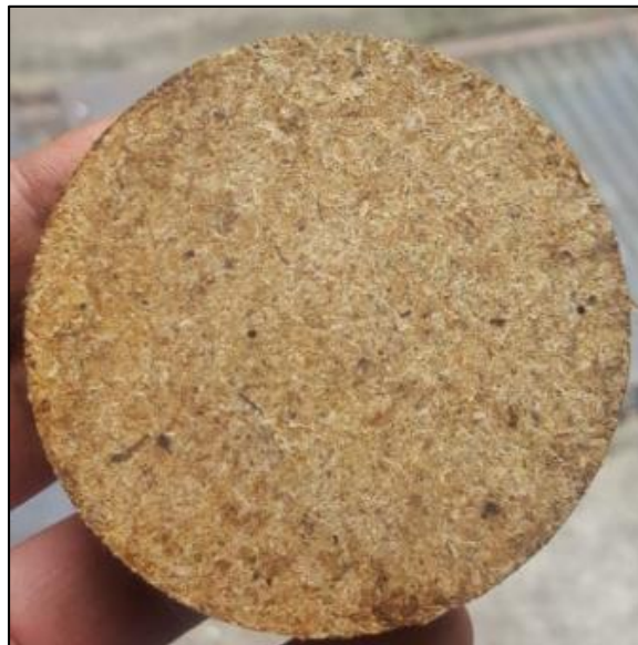
Figura 31. Comprimido de biomasa obtenido a partir de cascarilla de arroz.
