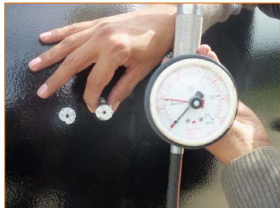
Resultado de la prueba, dando una adherencia de 750 Psi, 90% adhesiva. Resultado Inconforme, aunque da falla del pegante. Fuente: Autor.
