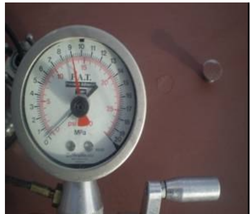
Equipo de adherencia a la izquierda, con 1300 lbs psi en la prueba y dado de metal despegado, con un resultado, 100% falla pegante. Fuente Autor
