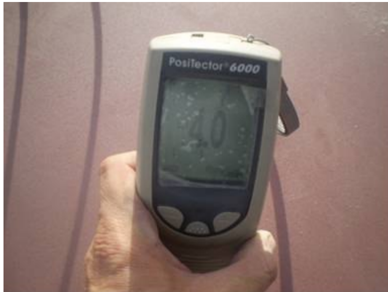
Medidor de Espesores Positector 6000 F1 s/n 73845. Fuente: Autor.
