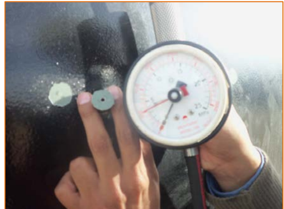
Resultado de la prueba, con 500 Psi de adherencia, 100% cohesiva. Resultado Inconforme, falla en la pintura. Fuente: Autor.
