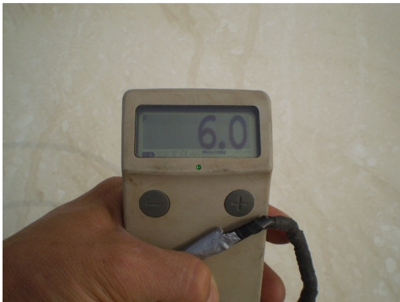
Medidor de Espesores Positector. Fuente: Autor.
