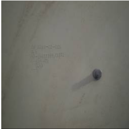
Dado de metal pegado en la lamina para realizar prueba de adherencia. Fuente: Autor.
