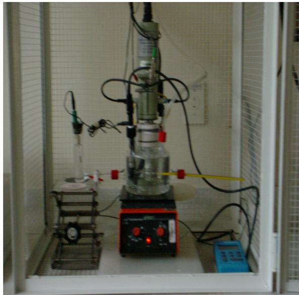
**Figura 13.** Potenciostato/Galvanostato EG&G Impedance Analyzer Modelo 6310
