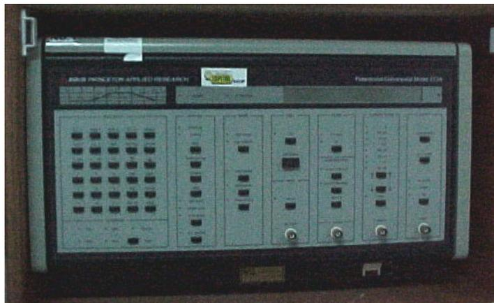
**Figura 15.** Analizador de respuesta de frecuencia modelo 1255 Schlumberger
