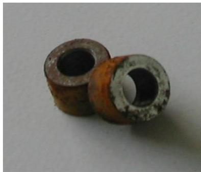
**Figura 34.** Formación de capas superficiales de productos de corrosión sobre el electrodo de acero al carbono en una solución de NaCl al 3% saturada con aire en la celda de impacto.
