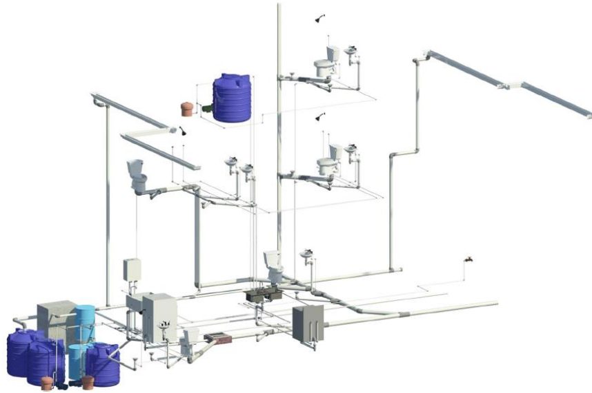
Figura 2. Redes de recolección y distribución del Sistema híbrido. Adaptada de Oviedo-Ocaña, E. R.; Dominguez, I.; Ward, S.; Rivera-Sanchez, M.L. and Zaraza-Peña, J. M. “Financial Feasibility of End-user Designed Rainwater Harvesting and Greywater Reuse Systems for High Water Use Households,” Environ. Sci. Pollut. Res. , vol. 25, no. 20, pp. 19200–19216, 2018
