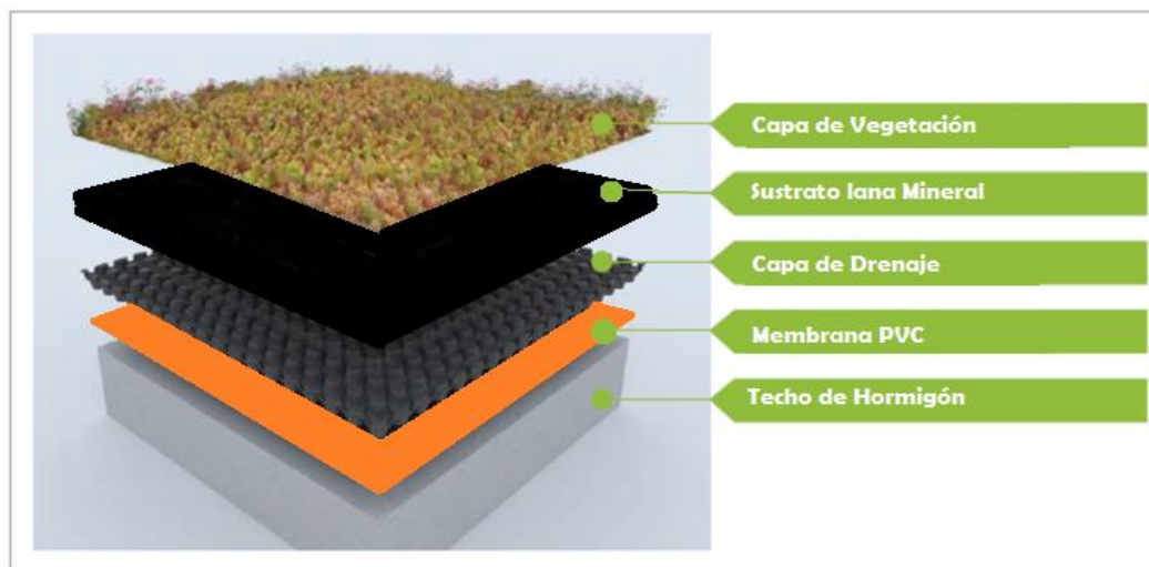
Figura 15. Capas del sistema de cubierta verde
