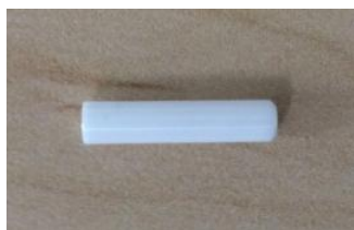
Figura 2. 3 Rotor de 4mm empleado para la caracterización por RMN.
