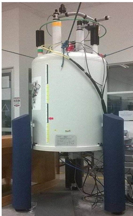
Figura 2.4 Espectrómetro de RMN de estado sólido de 9.4 Teslas. Ubicado en el laboratorio de RMN PTG UIS.
