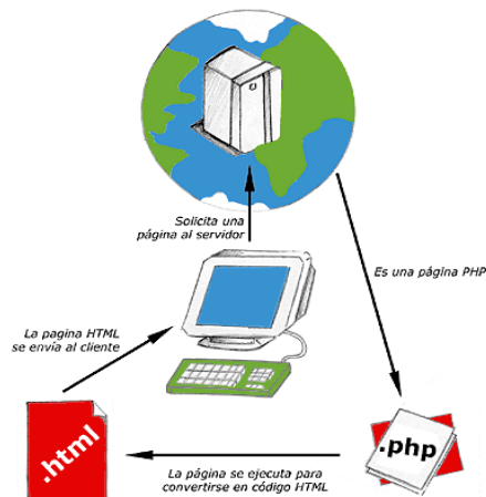
Figura 8. Esquema del funcionamiento de las páginas PHP.
