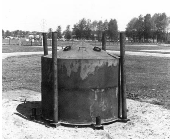
Figura 1. De izquierda a derecha, Preparación de horno y horno transportable completamente cerrado
