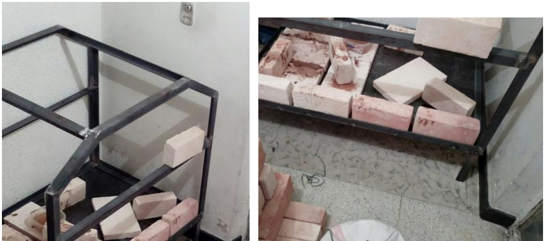
Figura 35 Estructura Interna del equipo soldada en ángulo de 1.1/2"
