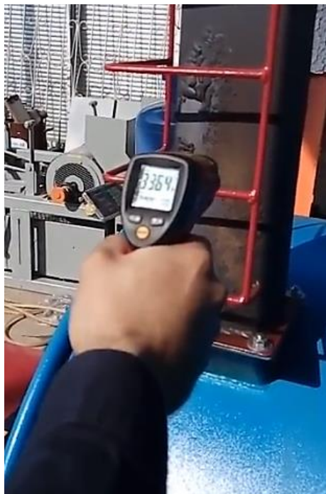
Figura 30. Medición de temperatura chimenea, primera prueba realizada con el quemador riello.
