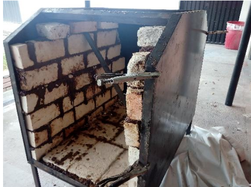
Figura 36 Preparación de tapas laterales para taladrar y roscar
