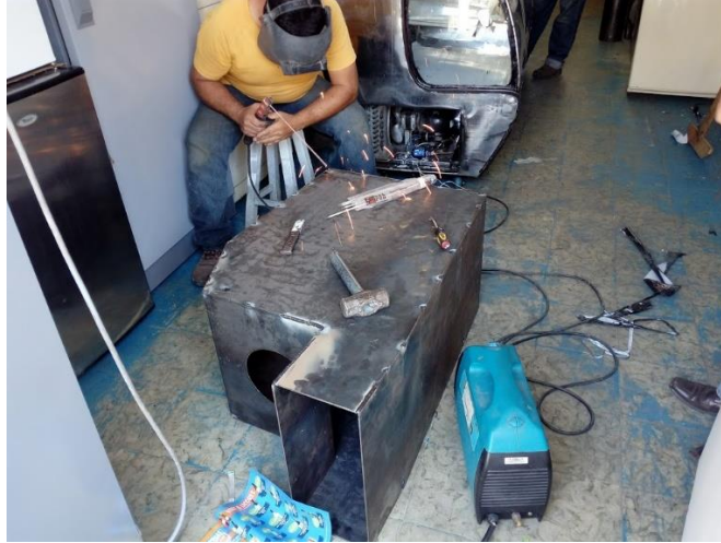
Figura 34 Construcción recamara interna con lámina laminada en frio de calibre de 3mm
