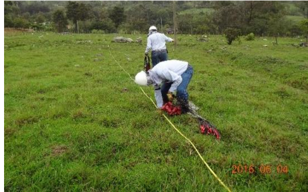
Ilustración 9. Localización de los geófonos para la línea de refracción
