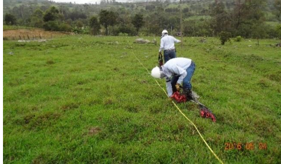
Ilustración 21. Multicable para la conexión de los geófonos.
