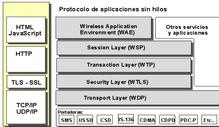
Figura 1: pila de protocolos WAP.
