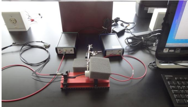
Figura 24. Montaje experimental para la medida del espectro de emisión del LED de tres longitudes de onda
