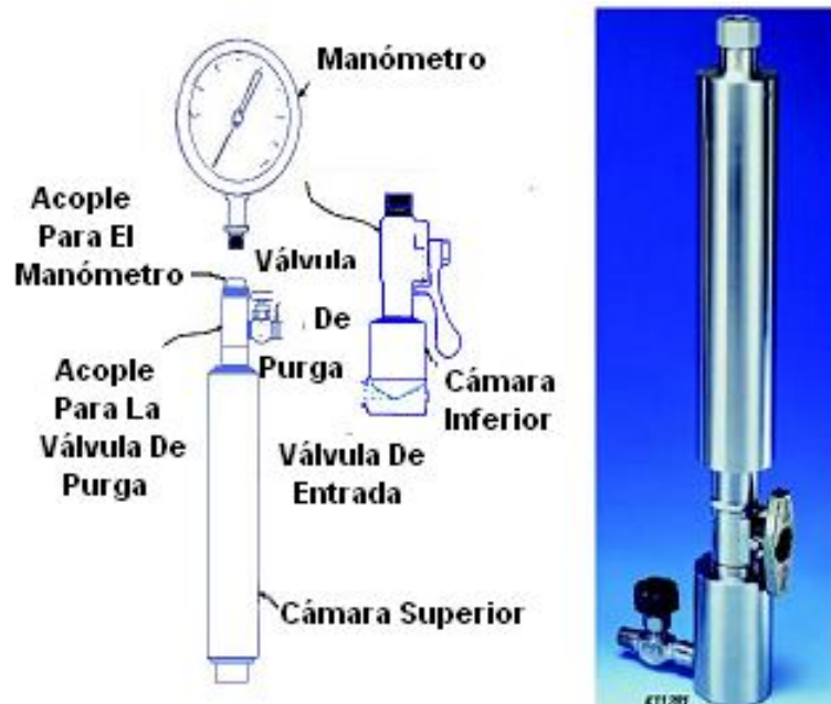
Figura 2. Equipo típico para medir la presión de vapor del GLP
