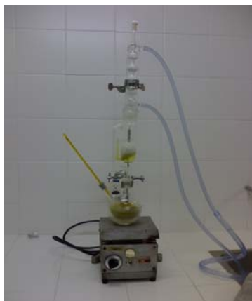
Figura 3. Equipo de extracción soxhlet
