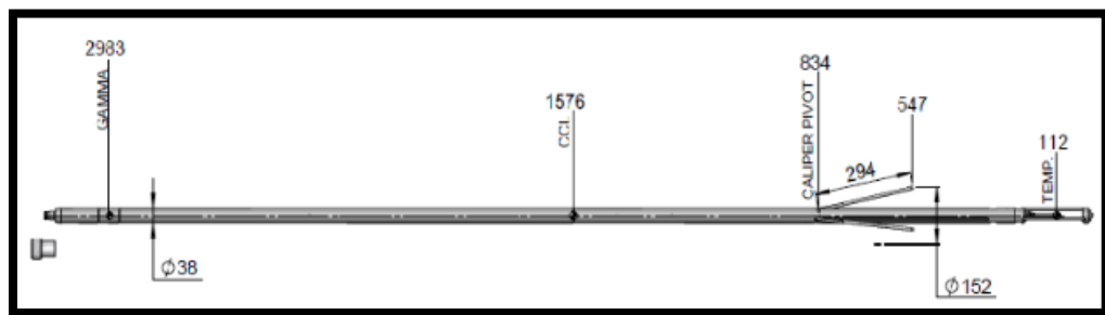
Figura 16. Sonda GTC. Realiza tres tipos de mediciones: Diámetro del pozo (caliper de 3 brazos)-Gama ray-Temperatura. Tomado de SLIMLINE, Weatherford, 2013.
