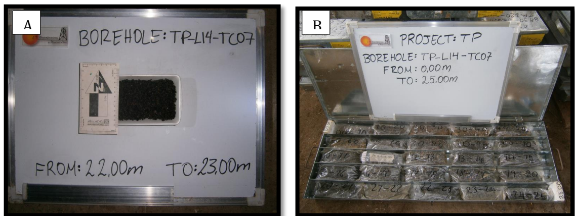
Figura 39. A. Muestras de rípios de carbón del pozo TP-L14-TC07. B. Muestra de rípios empacadas y almacenadas en las cajas.
