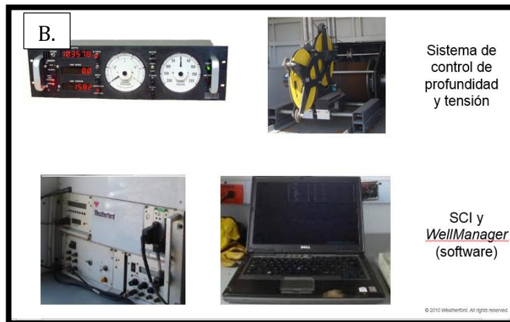
Figura 41. Generalidades del registro SLIMLINE. A. Unidades de Registro. B. Sistema de control de profundidad y tensión-SCI WellManager. Tomado de Weatherford 2013
