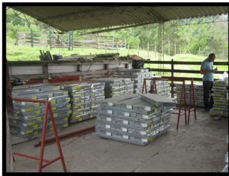
Figura 38. Descripción del núcleo de perforación durante la fase de campo.
