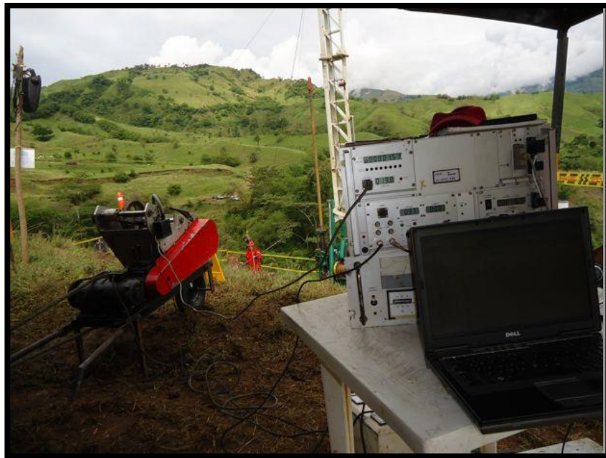
Figura 42. Campo de configuración en El Balsal. Cable y el draw works montados en una carretilla. La grabadora de superficie se monta de forma similar. Tomado de Weatherford 2013.
