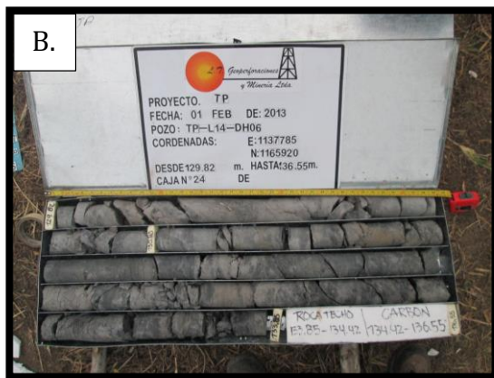
Figura 49: A. Carbón con brillo del 80%, sacado en el proceso de perforación a los 63 m aproximadamente de profundidad. B y C Nucleos organizado en las cajas con carbones en la base del pozo (134 a 136m). los núcleos con carbón han sido llevados para exámenes de laboratorio.
