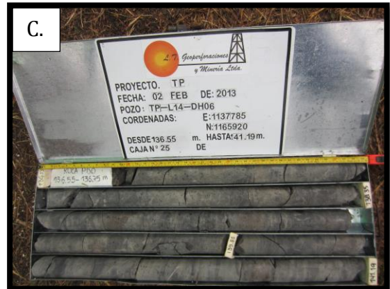
Figura 49: A. Carbón con brillo del 80%, sacado en el proceso de perforación a los 63 m aproximadamente de profundidad. B y C Nucleos organizado en las cajas con carbones en la base del pozo (134 a 136m). los núcleos con carbón han sido llevados para exámenes de laboratorio.
