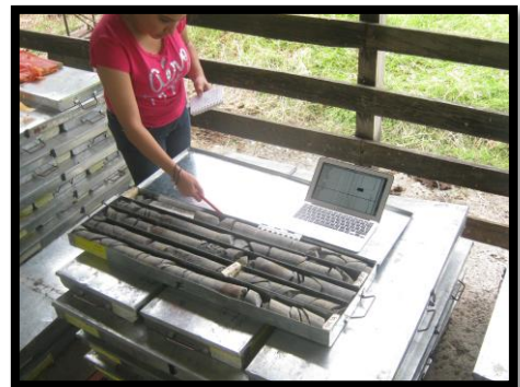
Figura 38. Descripción del núcleo de perforación durante la fase de campo.
