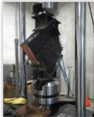
Figura 3. Compresión diagonal del murete
