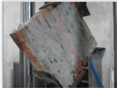
Figura 5. Falla en uno de los muretes utilizados en el experimento
