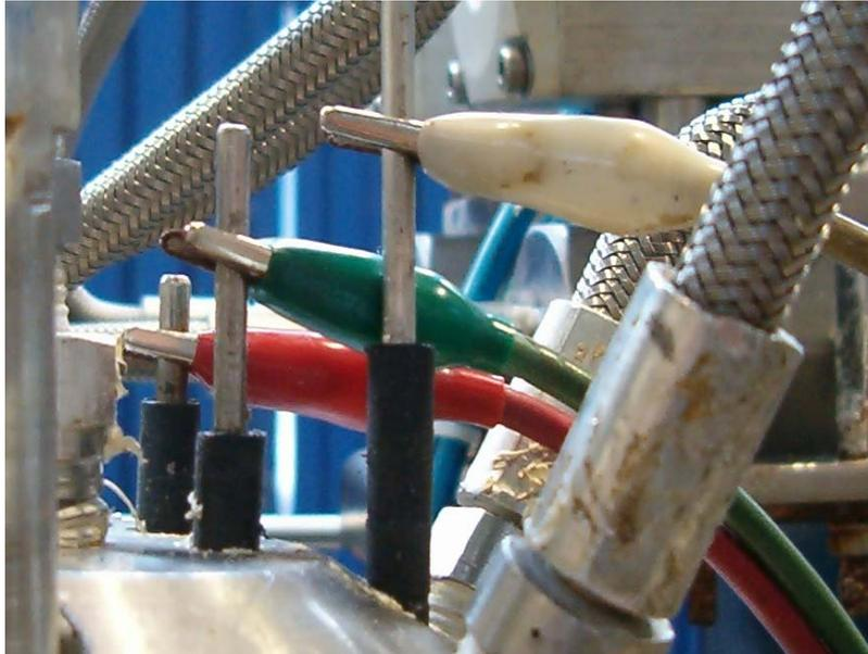
Para las pruebas denominadas *blanco*, un mismo volumen de electrolito permaneció en el autoclave desde el inicio hasta el final de la prueba. En estas pruebas no hubo renovación. Se efectuaron pruebas de resistencia a la polarización ( $R_p$ ) cada 6 horas.
