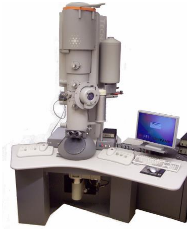
Figura 34. Anatomía de un microscopio electrónico de transmisión Tecnai F-20. Adaptado de: Center For Electron Microscopy and Nanofabrication. (June 23, 2010). FEI Tecnai F-20 Operations Manual
