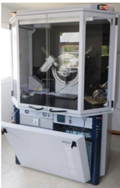
Figura 37. Difractómetro de rayos X D8 Advance. Adaptado de: Parque Tecnológico de Guatiguará. (sf). Página oficial. Disponible en: http://gtechpark.com/
